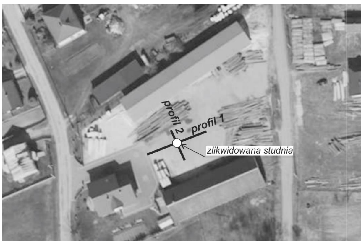
Rys. 1. Mapa poglądowa z lokalizacją przeprowadzonych badań georadarowych (lokalizacja zlikwidowanej studni)
